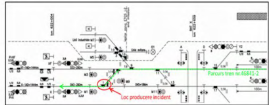
fig2 - poziția schimbătorului de cale centralizat nr.1 și parcurusul trenului
